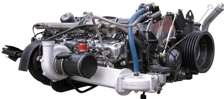
Vývoj CNG verze motoru probíhá dvěma směry: motory pro spalující chudou směs a motory spalující stechiometrickou směs. **Plynový motor spalující chudou směs** má typové označení TG 210. Tento motor má elektronicky řízené vícebodové dávkování plynu před jednotlivé válce. Motor je plně elektronický – komunikuje prostřednictvím sběrnice CAN s ostatními elektronickými systémy vozidla (ABS, TCS, rychloměr aj.). Řídicí jednotka má archivaci parametrů motoru pro případ analýzy
