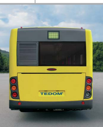
zad' ze sklolaminátu, víko motoru z hliníku
